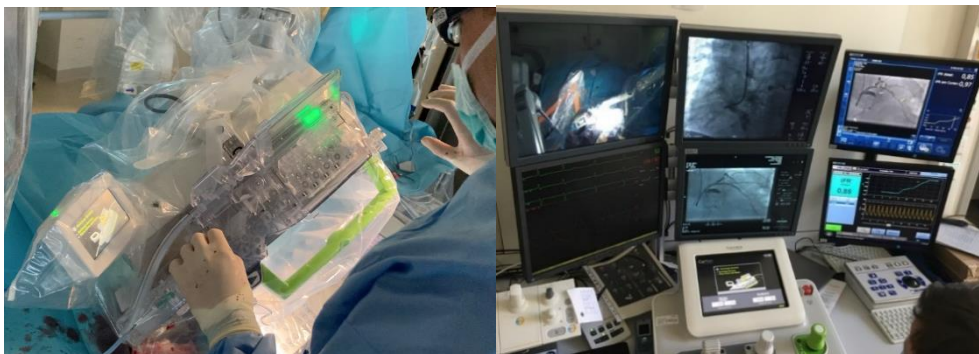
Abb. 2: Links: Steril abgedeckter Roboterarm im Katheterlabor. Rechts: Kontrollkonsole mit Monitoren.
